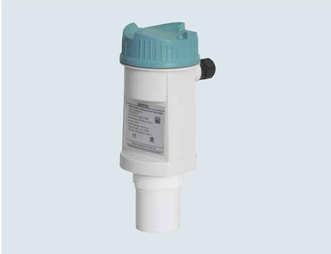
SITRANS LU150 是一款一体化的小量程超声波物位变送器。这个两线制，4 到 20 mA 回路供电型物位变送器通常适用于开放或封闭容器中的液体，浆料和散装物料，容器高度高可达 5 米（16.4 英尺）。
