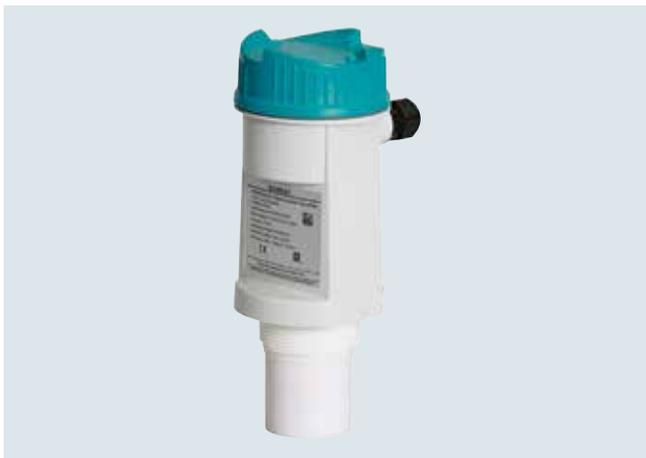
SITRANS LU180 是一款小量程的一体式超声波物位计。这款本安型变送器采用 2 线制的 4 到 20 mA 回路进行供电，是高达 5 米 (16.4 ft) 开放式 / 封闭容器内液体、浆料和散装物料测量的理想之选。
